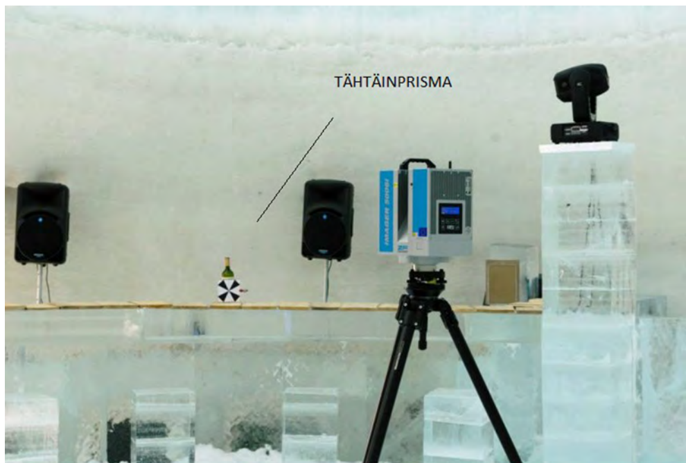
Kuva 15. Laserkeilaimen tähtäinprismat lumirakennemittauksessa 61
