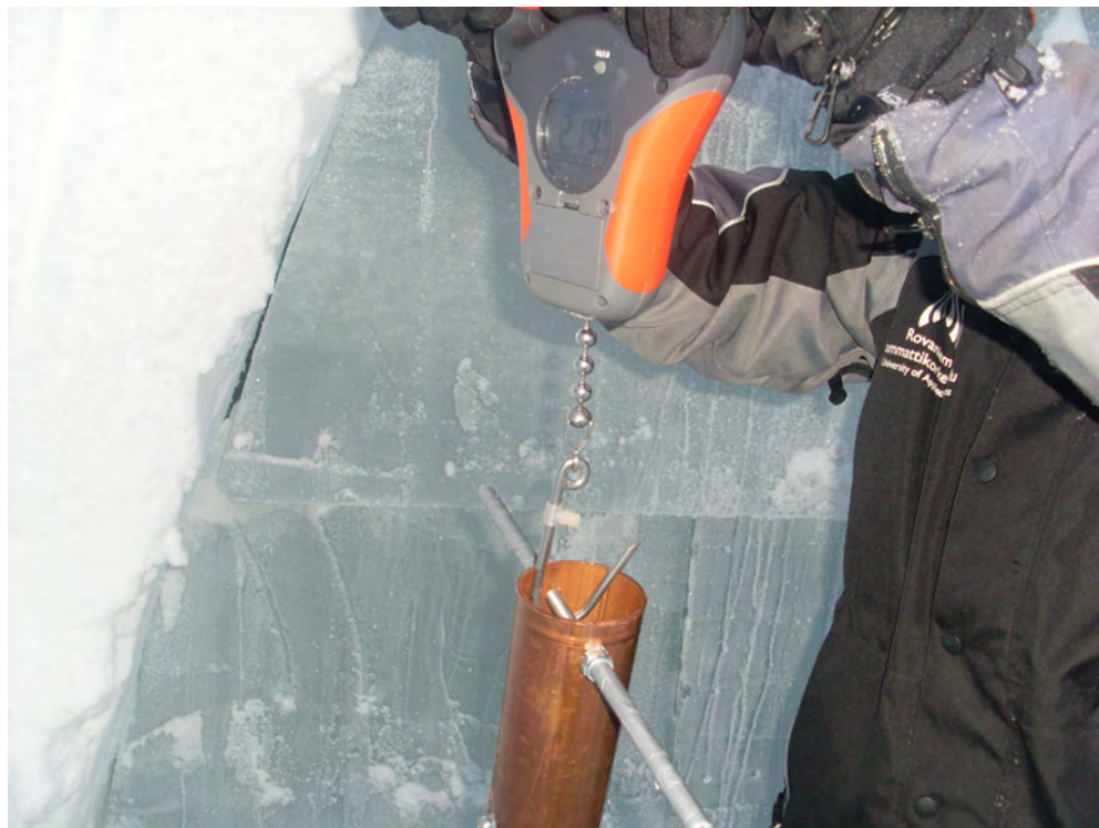
Kuva 19. Lumentiheyden mittaaminen putken ja vaa'an avulla 68
