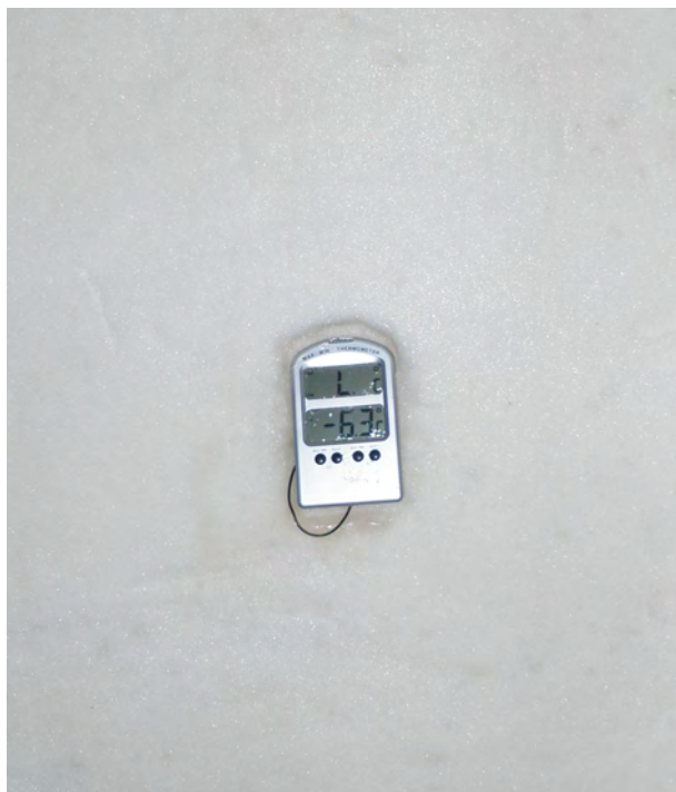
Kuva 16. Digitaalinen sisä-/ulkolämpömittari lumirakenteessa 64
