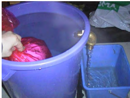
Kuva 18. Luminäytteen tiheyden määrittäminen upotuskokeella 67
