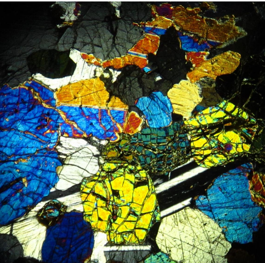
Oliiviinipyrokseeniittia (vas.) (5 x suurennos, ristipol.). Klinopyrokseenia (oik. ylh.) (10 x suurennos, ristipol.). Oliiviinia (oik. alh.) (10 x suurennos, ristipol.).
